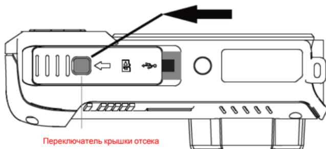
Переключатель крышки отсека
