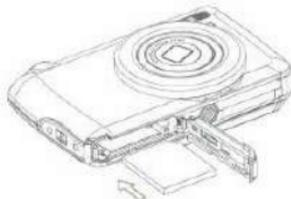
3. Spingere la scheda finché non scatta in posizione. La parte superiore della scheda deve essere a filo con la superficie della fotocamera. Quando la fotocamera è accesa, sullo schermo LCD viene visualizzata l'icona "SD".
